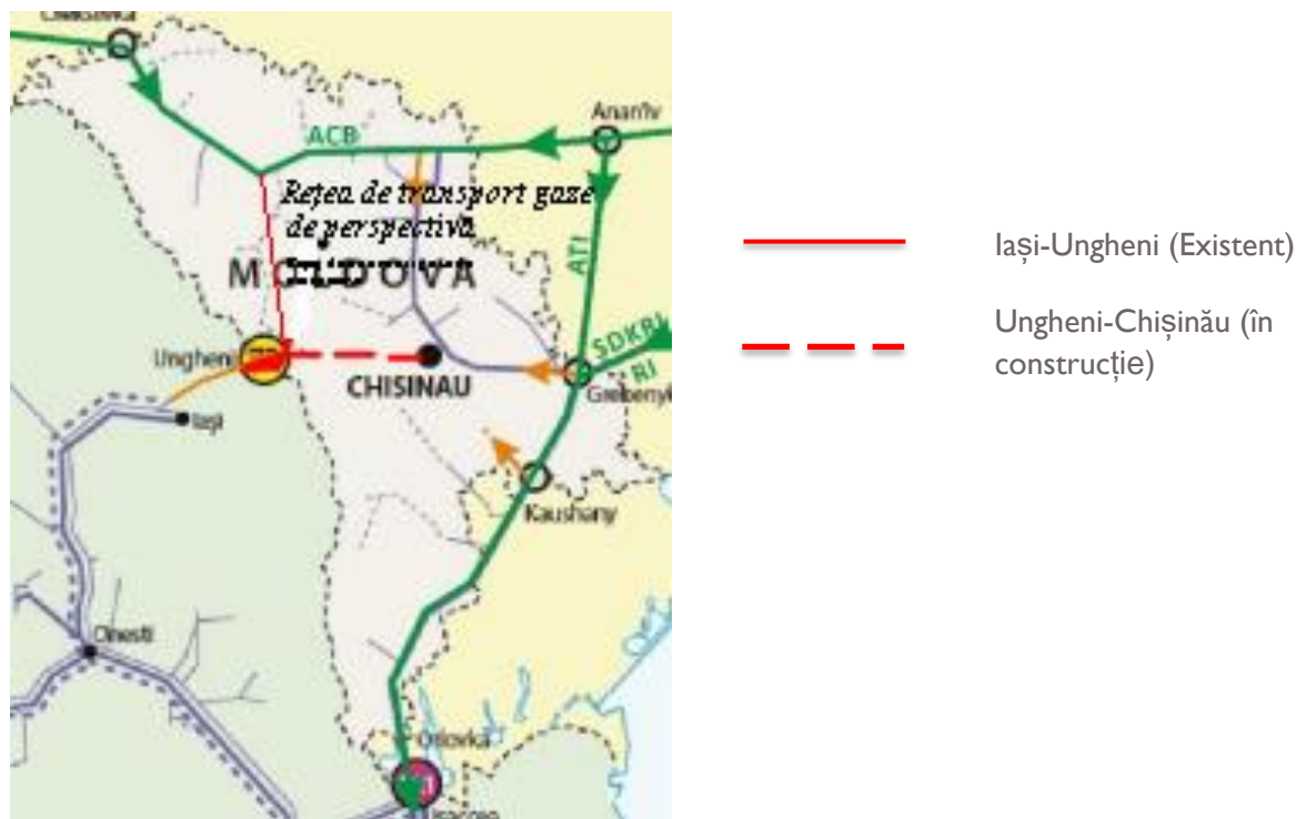
Reprezentarea 117 Infrastructura de exploatăată de Vestmoldtransgaz, (conform Vestmoldtransgaz)
